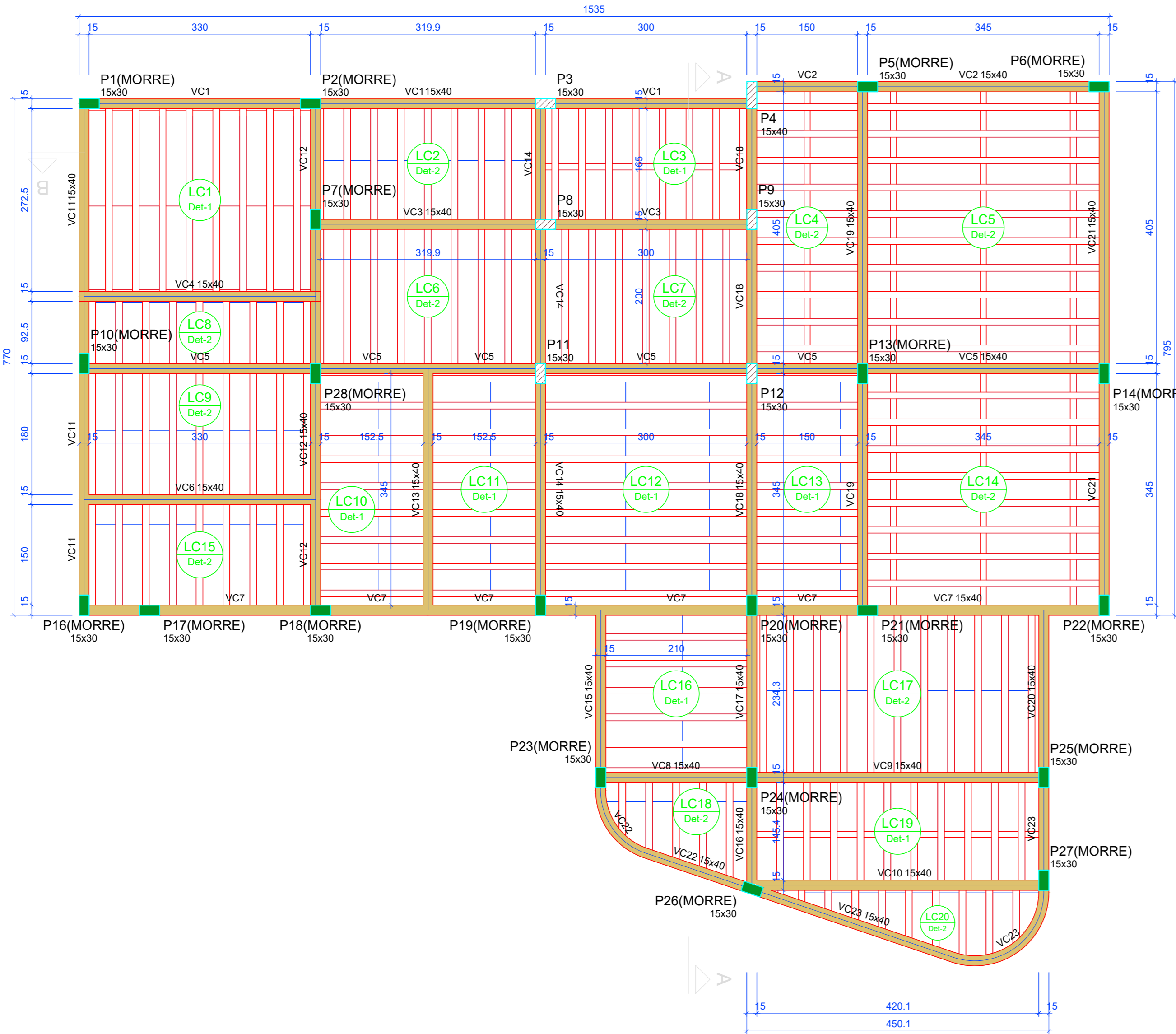
Forma do pavimento COBERTA (Nível 576) escala 1:50
